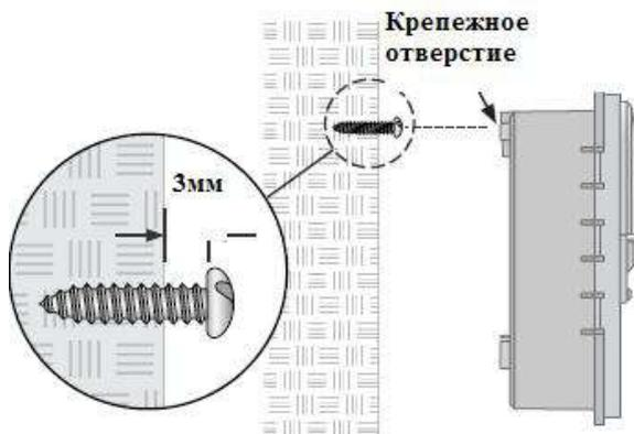
► Второй крепежный винт нужно винтить в стену через открытое отверстие внутри контроллера, там, где находятся клеммы. Убедитесь, что устройство надежно закреплено на стене.
